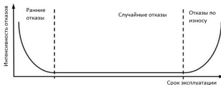
Рис. 3. Зависимость интенсивности отказов от времени - U-образная кривая
