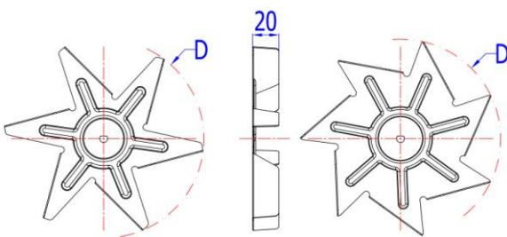
D=  $\varnothing 152$ mm for either 6 or 7 fan blades
